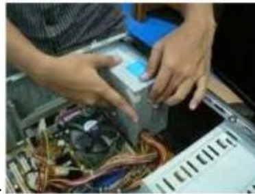
Gambar 3. Cara Memasang Power Supply (PSU) Pada Casing
