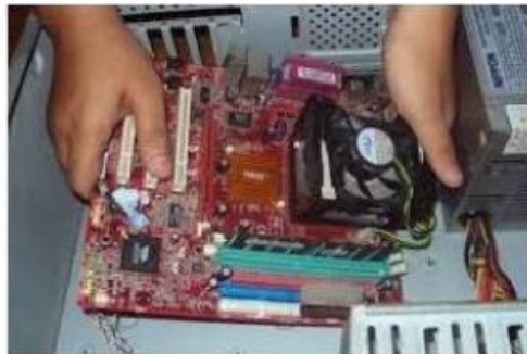
Gambar 5. Cara Memasang Motherboard ke Casing
