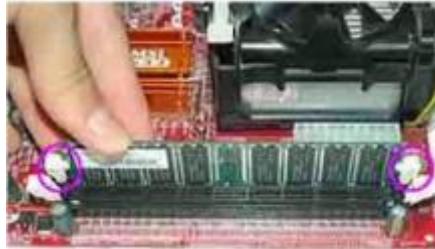
Gambar 2. Cara Memasang RAM / Memori ke Motherboard
