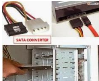
Gambar 4. Cara Memasang Harddisk Dan CD Atau DVR-RW
