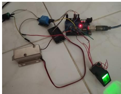
Gambar 23 Solenoid posisi terkunci
