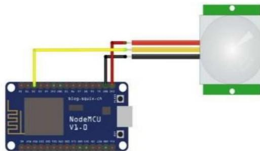
**Gambar III.3 Rangkaian Sensor Pir pada NodeMCU**
