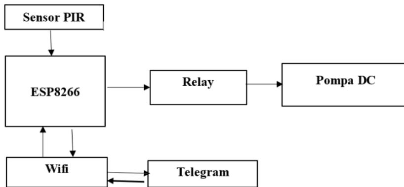
Gambar III.1 Diagram Blok Sistem
