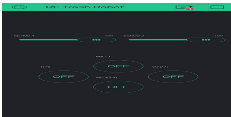
Gambar 7: Hasil Pengujian Monitoring Motor Menggunakan Blynk
