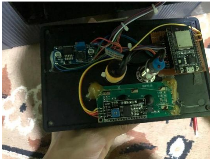
Gambar 5. Rancangan Hardware ESP32 ke sensor Metal dan Non metal
