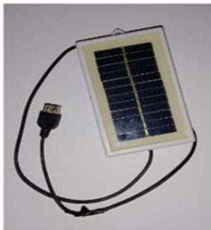
Gambar 2. Panel Surya 6 Volt Sumber: (Hasrul, 2021)
