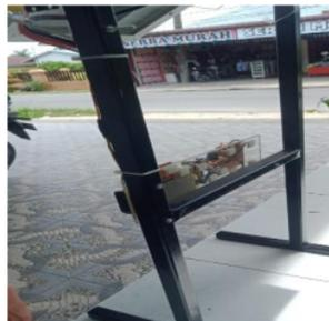
Kerangka Solar Tracker terbuat dari besi dengan tinggi 40 cm dan lebar 15 cm, dirancang untuk menopang panel surya dan komponen elektronik. Besi dipilih karena kuat dan tahan terhadap cuaca. Dimensi ini memberikan stabilitas untuk mengikuti pergerakan matahari dan memaksimalkan penyerapan cahaya, serta memudahkan pemasangan dan perawatan.
