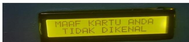
Gambar 5. Tampilan LCD Kartu yang belum terdaftar
