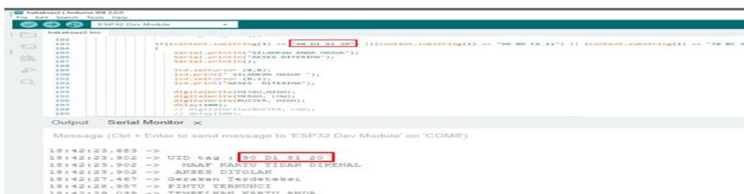
Gambar 4. Tampilan No Kartu yang terbaca dan didaftarkan di Arduino IDE
