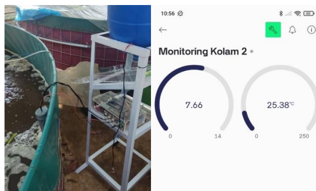
Gambar 2. Implementasi Sistem Monitoring Suhu dan pH Berbasis IoT dan Tampilan pada Blynk.
