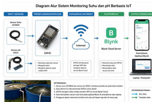
Gambar 1. Diagram Alur Sistem Monitoring Suhu dan pH Berbasis IoT.
