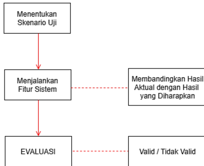
Gambar 1. Alur Pengujian Menggunakan Metode Black Box Testing.
